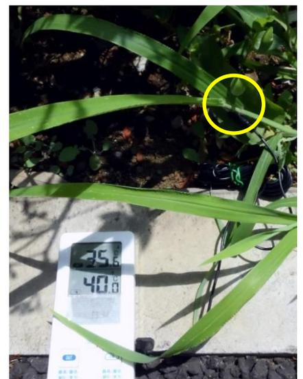
リートの上の温度がぐんぐん高くなってきます。これは温められたコンクリートからの輻射熱によるものです。一方、草むらの中に置いたセンサーの示す温度は少しずつ低くなって36℃台を示しました。センサーを地表近くの日陰に置いているから気温が低いのかと思って、今度は右の写真のように、センサーを野草の葉の上に置いてみました。また、数分後に表示を見ると、なんと草の葉の上に置いたセンサーが感じる温度はさらに下がって35.6℃。コンクリートの上よりも4℃以上低いのです。使っているデジタル温度計の精度は良くないので正確なものではありませんが、同じ炎天下でもコンクリートの上よりも草むらの葉の上はかなり温度が低いことが分かりました。
