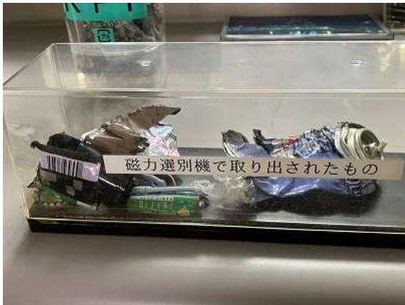
👉 粉碎した使用済みプラスチックの中から取り除いた異物
